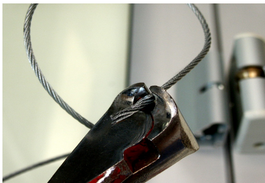
1) Couper proprement le bout du câble.
